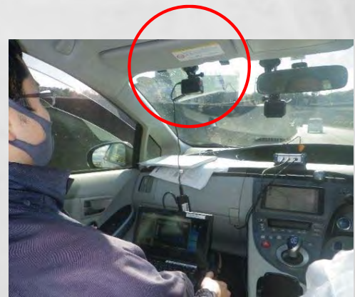
カメラ設置状況
