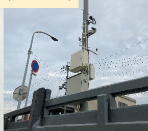
橋梁（電波流速計）
