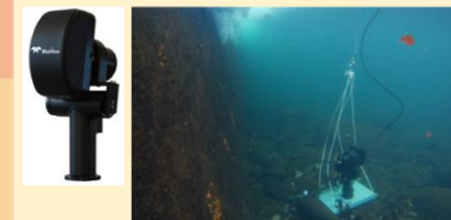
水中音響 3D スキャンニングソナーによる計測状況 Teledyne BlueView 社製 3D スキャンニングシステム
