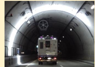
走行型自動計測（点検支援技術）
