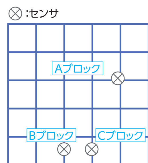
従来の漏水検知方式のイメージ
