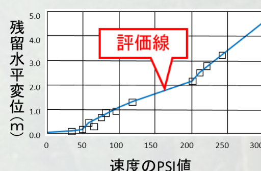
速度の PSI 値と施設被害評価指標の整理例(残留水平変位の例)
