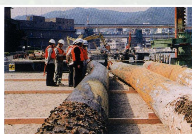
阪神淡路大震災における栈橋式係留施設の損傷事例（健全に見えたが鋼管杭が座屈していた）
